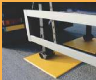
Placas de Reboque usadas para proteger o piso do centro de distribuição.
