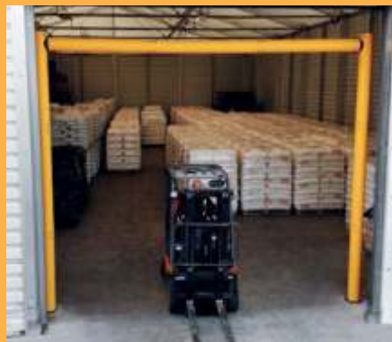
Limitador de Altura que proporciona orientação visual e proteção física para condutores
